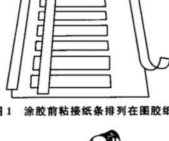
图 1 涂胶前粘接纸条排列在图胶纸上
